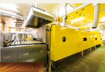
◀焼成中の状態をオープンの窓から目視。工場内の環境に合わせて、温度や湿度の調整が欠かせません。
