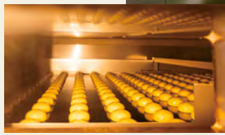
◀焼成中の状態をオープンの窓から目視。工場内の環境に合わせて、温度や湿度の調整が欠かせません。
