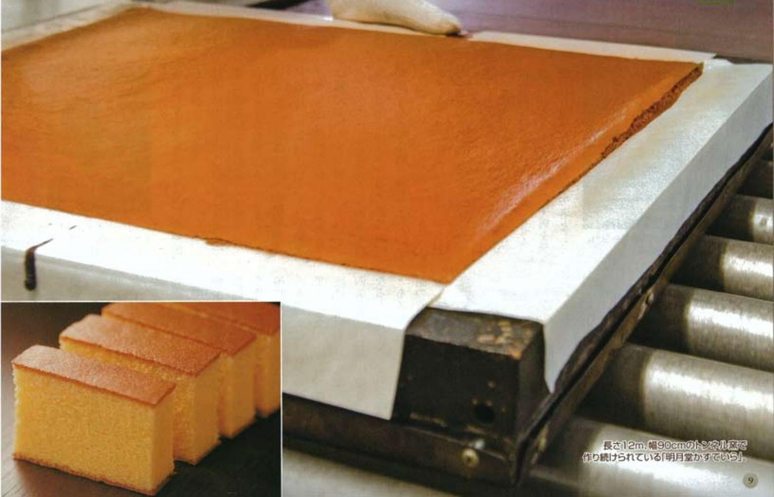
長さ12m、幅90cmのトンネル窯で
